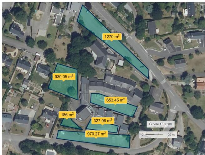
Figure 5: Surfaces accessibles à l'implantation des sondes géothermiques
